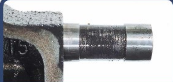
Automatikgetriebe-Gehäuse mit Rückständen
