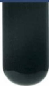
Abgenutztes, oxidiertes Getriebeöl
