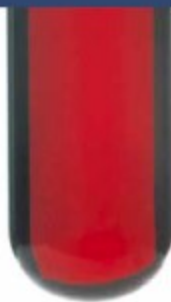
Probe nach Anwendung des BG Automatik- getriebe-Services
